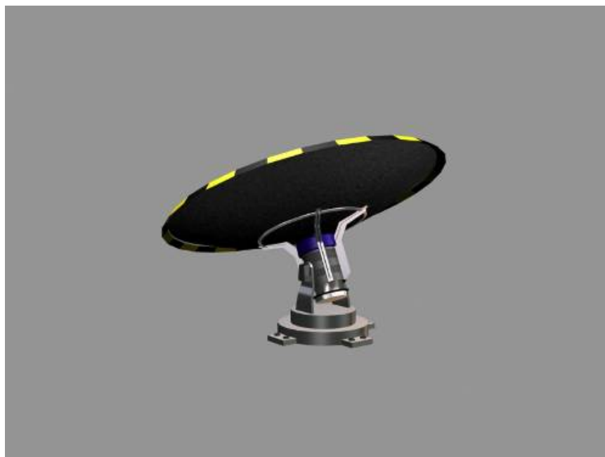
Gráfico 1.2. Vista Posterior del Concentrador Parabólico con motor Stirling en su base
